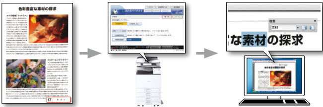
①文字入り原稿 ②OCR設定をしてPDFに変換。③作成されたPDFにテキストデータが埋め込まれます。
