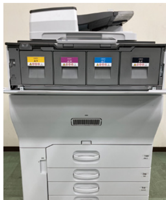
RICOH IM C6500トナーボトル補給部 (ドアを開いた状態)
